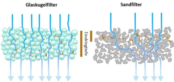
Bei Sandfiltern wird für die eigentliche Filtration nur eine schmale Schicht an der Oberseite des Filters genutzt. Bei Glasfilterkugeln kann der Schmutz deutlich tiefer vordringen, die nutzbare Menge an Filtermaterial ist größer.
